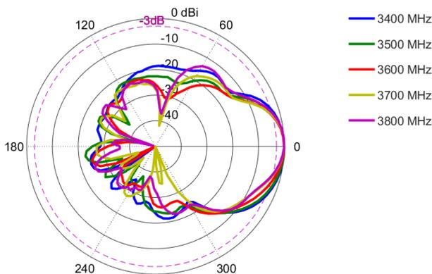
**Elevation (Side View): 3400 – 3800 MHz**
